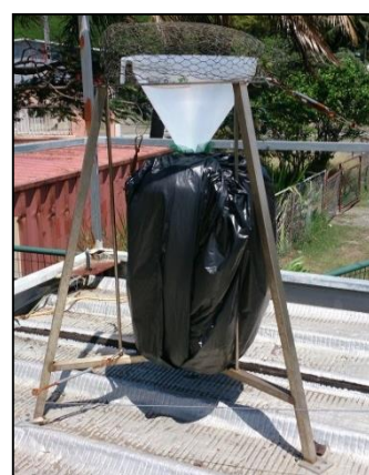
Figure 2 : Jauge Owen installée sur le toit de la station de Montravel
